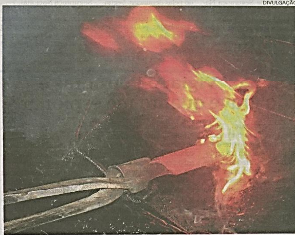
Foice é forjada de modo semiartesanal na LP Ferramentas: diferencial na qualidade
